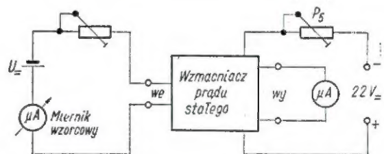
Rys. 7. Schemat układu pomiarowego do kalibracji wzmacniacza prądu stałego
