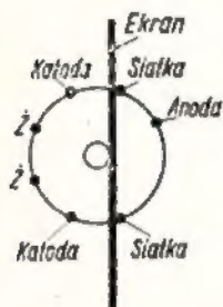
Rys. 5. Sposób umieszczenia ekranu na podstawie lampowej (dla lampy typu PC96)
