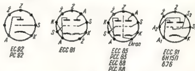
Rys. 8. Cokoly lamp możliwych do zastosowania w konwerterze
