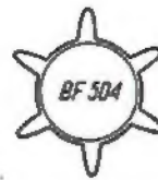
Rys. 12. Radiator tranzystorów średniej mocy
