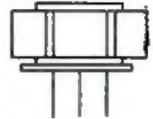
Rys. 12. Radiator tranzystorów średniej mocy
