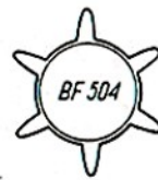
Rys. 12. Radiator tranzystorów średniej mocy
