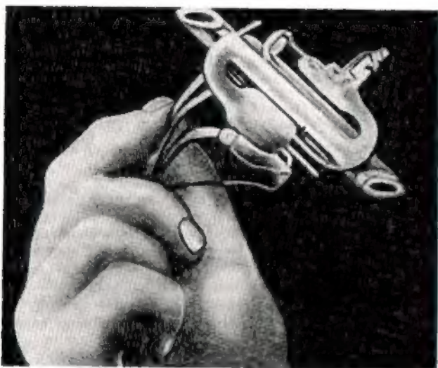
Rys. 3. Miniaturowy laser He-Ne (Bell Telephone Laboratories)
