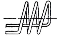
Rys. 6. Wykonanie cewek dla wyższych zakresów
