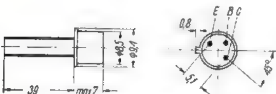
Rys. 1. Rozmiary tranzystorów grupy BF504-506 oraz układ wyprowadzeń elektrod
