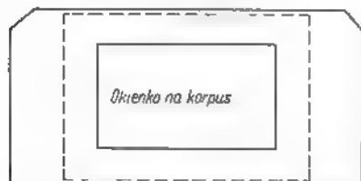
Rys. 6. Płytkę do umocowania transformatora sieciowego
