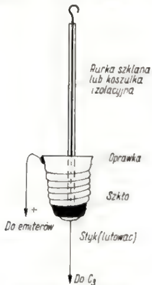
Rys. 4. Szczegóły konstrukcyjne wyjścia multiwibratora
