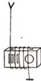
Rys. 3. Najprostszy sposób przyłączenia anteny zewnętrznej do odbiornika turystycznego
