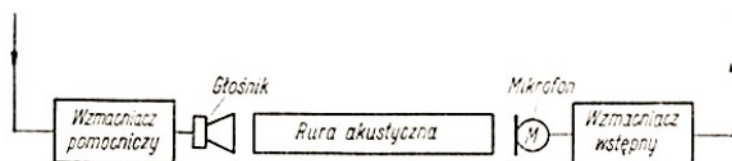
Rys. 24. Schemat blokowy uproszczonej aparatury opóźniającej
