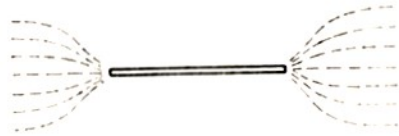
Rys. 1. Pręt anteny ferrytovej „skupia w sobie” linie sił pola magnetycznego
