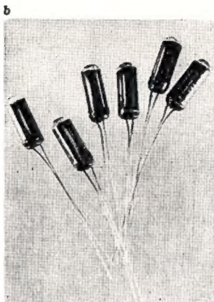
Rys. 2. Fotodiody FG2 — wygląd zewnętrzny Fot. J. Tymliński a — przed pomalowaniem, b — pokryta lakierem ochronnym
