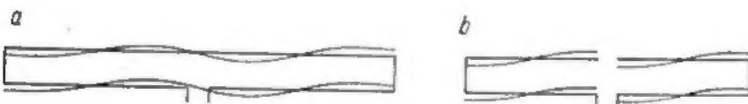
Rys. 3. Rozkład napięcia w dipolu pętlicowym: a - o długości 3/2 \lambda , b - o długości \lambda .
