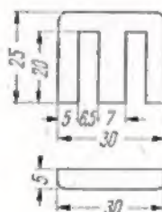
Rys. 11. Blaszka transformatora Tr2; grubość blachy 0,4 mm
