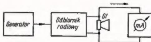
Rys. 2. Schemat przyłączeń przyrządu do odbiornika
