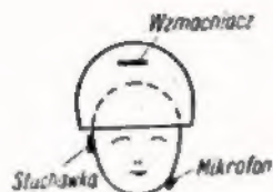
Rys. 3. Przykład rozmieszczenia elementów urządzenia
