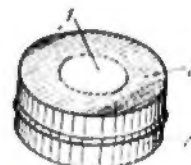
Rys. 6. Sposób zabezpieczenia okładzin akumulatora przed przenikaniem elektrolitu
