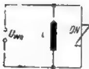
Rys. 7. Układ ze zbczniczowaną cewką
