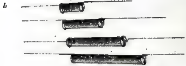
Rys. 5. Kondensatory ceramiczne a — talerzykowe, b — rurkowe
