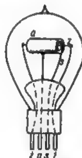
Rys. 4. Konstrukcja najprostszej lampy trójelektrodowej (dawny typ)
