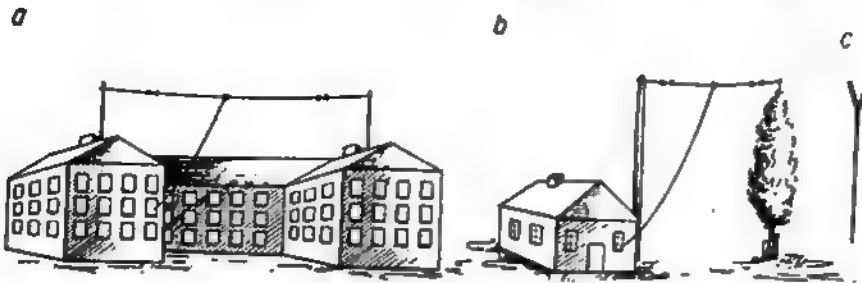
Rys. 1. Antena odbiorcza a - przykład wykonania w warunkach miejskich, b - w warunkach wiejskich, c - symbol stosowany w schematach ideowych
