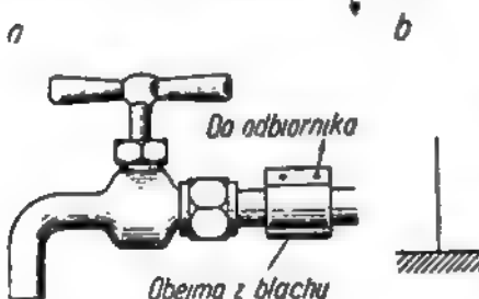
Rys. 2. Uziemienie odbiornika a - przykład wykorzystania rury wodociągowej, b - symbol stosowany w schematach ideowych
