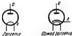
Rys. 4. Schemat ideowy diody bezpośrednio żarzonej i z katodą podgrzewaną
