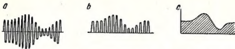
Rys. 3. Demodulacja drgań wielkiej częstotliwości w układzie detektora
