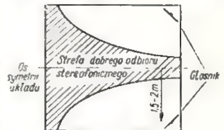
Rys. 4. Rozmieszczenie głośników zestawu w małym pokoju mieszkalnym
