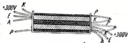
Rys. 4. Rozmieszczenie uzwojeń transformatora Tr1
