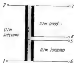
Rys. 1. Schemat ideowy i wygląd zewnętrzny transformatora sieciowego
