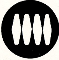
Rys. 27. Obraz przy próbie dwutonowej, gdy wzmacniacz jest przesterowany lub źródło sterujące posiada złą stabilizację przy sterowaniu wzmacniacza klasy AB 2
