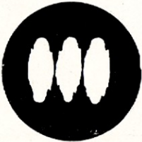
Rys. 29. Próba dwutonowa; obraz przy drganiach pasożytniczych na częstotliwości pracy
