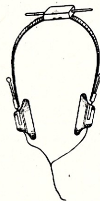
Rys. 8. Przykład konstrukcji miniaturowego odbiornika turystycznego z zastosowaniem popularnych słuchawek radiowych
