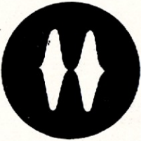
Rys. 28. Próba dwutonowa; obraz przebiegu zmodulowanego SSB podobny do obrazu dla AM. Objaw charakterystyczny dla zbyt dużego minusa siatkowego, któregoś ze wzmacniaczy lub mieszaczy
