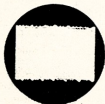
Rys. 22. Obraz na ekranie oscyloskopu dla wzбудnicy sterowanej jedną częstotliwością akustyczną
