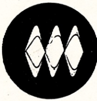
Rys. 26. Próba dwutonowa; obraz przy obecności pasożytniczych drgań ultrakrótkofalowych w nadajniku
