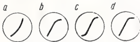
Rys. 21. Przebiegi obserwowane na ekranie oscyloskopu z układu pomiarowego na rys. 17. Przedstawiają one charakterystyki liniowości badanego wzmacniacza.
