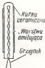
Rys. 1. Katoda lampy pośrednio żarzonej (w przekroju)
