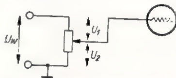
Rys. 3. Zasada regulacji wzmocnienia za pomocą potencjometru
